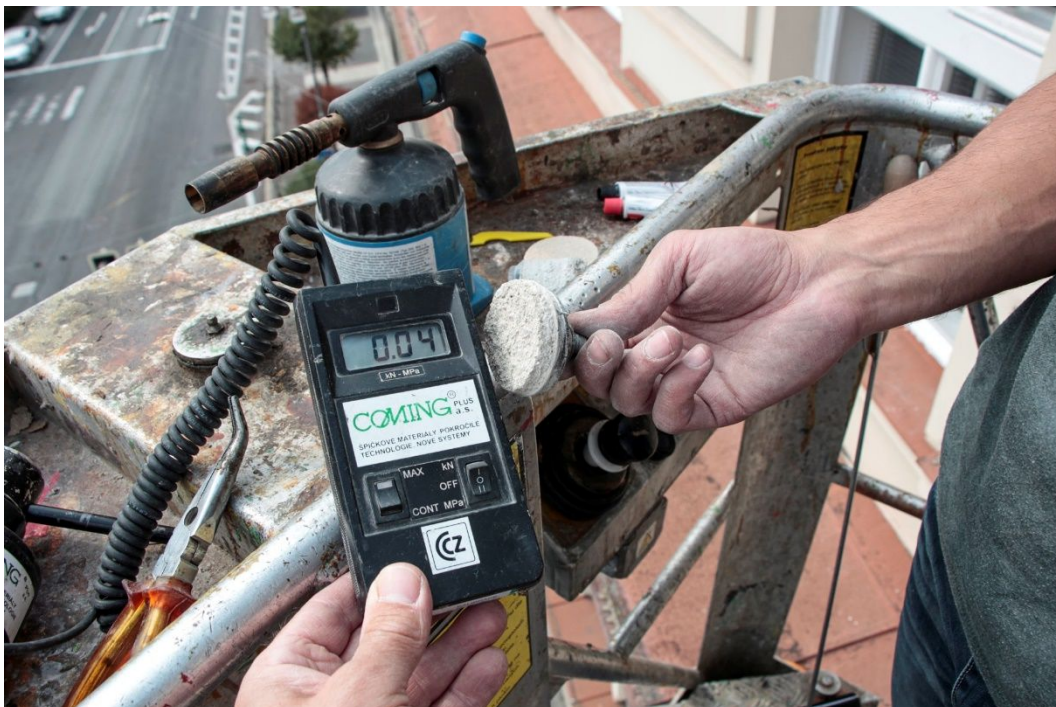
44. Zkušební místo č. 5, zjištěná hodnota přidrženosti omítky.
