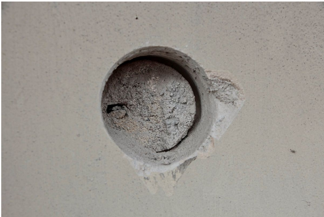
43. Zkušební místo č. 2 ke kontrole přidrženosti omítky. Nízká pevnost malty způsobila téměř nulovou přidrženost omítky, která se při trhací zkoušce oddělila v jádrové vrstvě.
