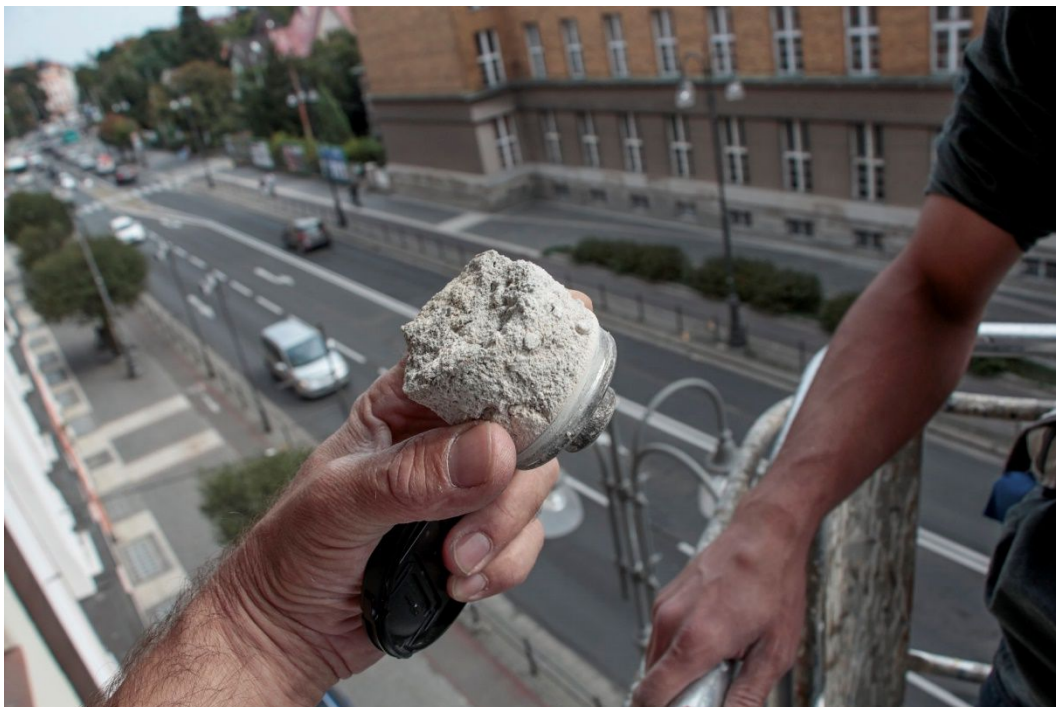
42. Značná tloušťka omítky (5 cm) na zdivu v místě č. 2 zkoušky přídržnosti omítky.
